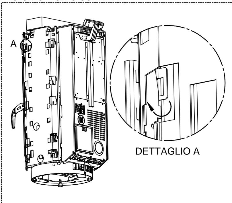
5 - Coloque los cuatro perfiles de compensación (l, L, M, N), encajando los ganchos de los mismos en las ranuras correspondientes, presentes en el cuerpo del equipo. En algunos casos es necesario romper el último gancho inferior del perfil superior.
