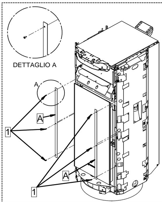
1 - Coloque los dos perfiles de compensación (A) con los tornillos (1) en los laterales del equipo, tal como se muestra en la figura.
