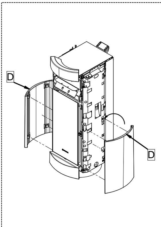
5 - Enganche el lateral inferior (D) en los dientes correspondientes. Deforme ligeramente los dientes con el fin de fijar firmemente la mayólica al cuerpo. Siga el mismo procedimiento en el lateral opuesto.
