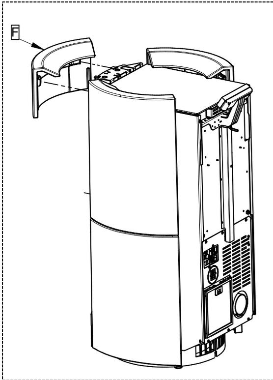
10 - Enganche la mayólica superior (F) en los dientes correspondientes. Deforme ligeramente los dientes con el fin de fijar firmemente la mayólica al cuerpo.
