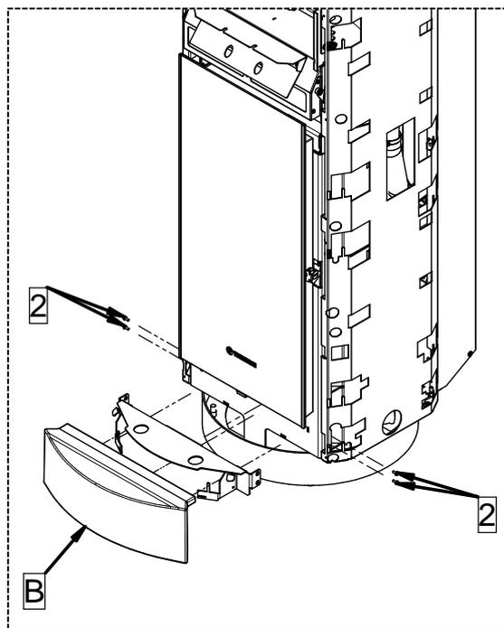
2 - Desenrosque los 4 tornillos (2) y quite el estribo de soporte de la mayólica. Coloque la mayólica inferior (B) en el estribo recién quitado. Por último, fije el estribo con la mayólica, utilizando los 4 tornillos (2) recién quitados.
