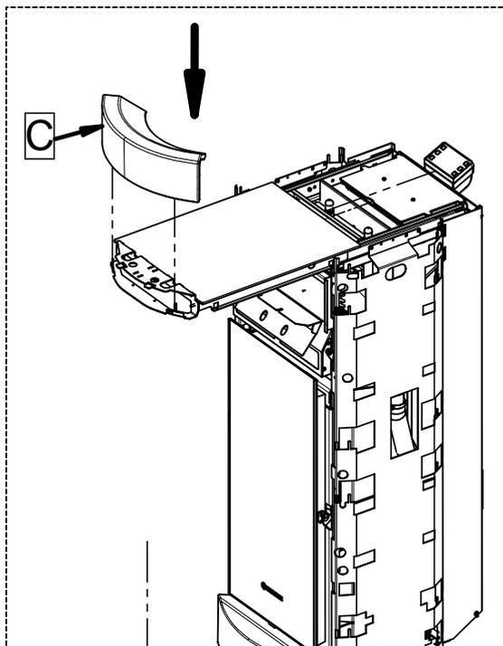
3 - Extraiga la bandeja e introduzca la mayólica superior (C) en los dientes correspondientes. Deforme ligeramente los dientes con el fin de fijar firmemente la mayólica al cuerpo.
