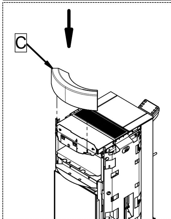
4 - Enganche la mayólica superior (C) en los dientes correspondientes. Deforme ligeramente los dientes con el fin de fijar firmemente la mayólica al cuerpo.
