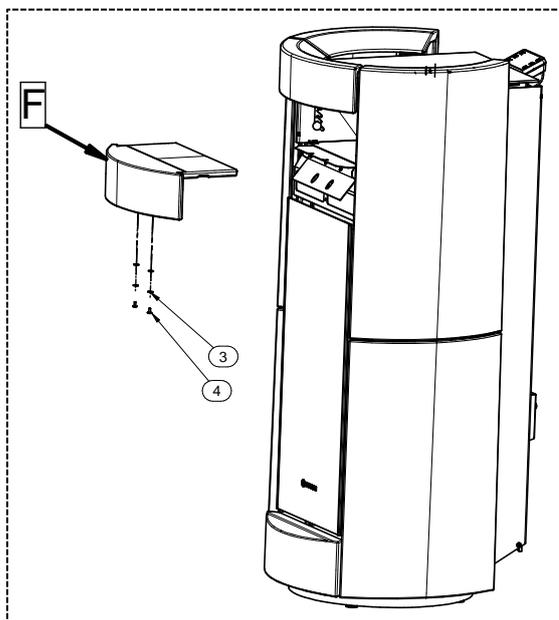
7 - Solo para los productos de aire, introduzca la mayólica central (F) tal como se muestra en la figura. A continuación, fíjela con los tornillos (4) y las arandelas (3).
