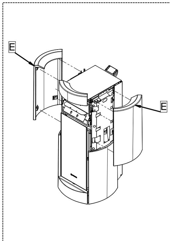
6 - Enganche el lateral superior (E) en los dientes correspondientes, como se hizo anteriormente. Deforme ligeramente los dientes con el fin de fijar firmemente la mayólica al cuerpo. Siga el mismo procedimiento en el lateral opuesto.
