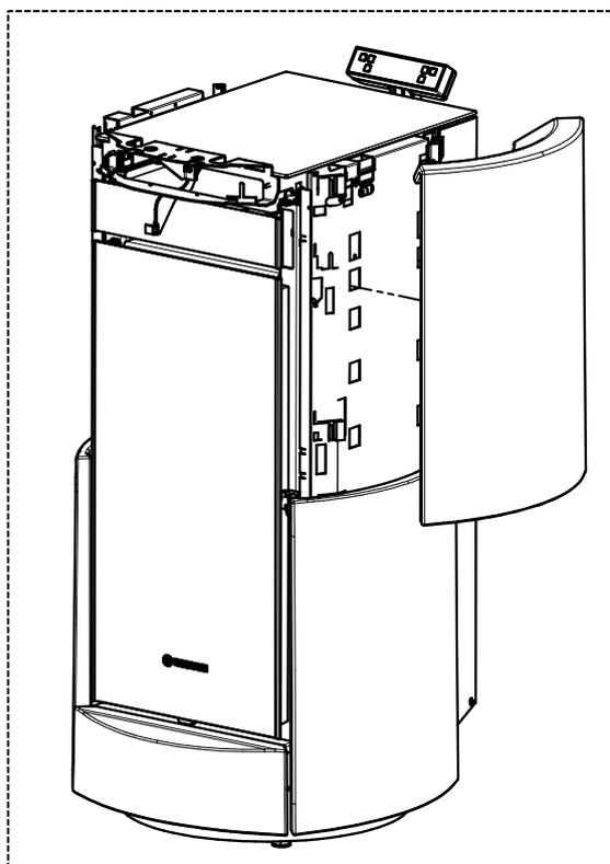
7 - Enganche el lateral inferior (E) en los dientes correspondientes, como se muestra en los detalles C y D. Deforme ligeramente los dientes con el fin de fijar firmemente la mayólica al cuerpo. Siga el mismo procedimiento en el lateral opuesto.
