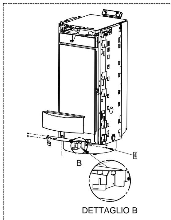
4 - Regolare i due dentini di cui al DETTAGLIO B in modo da rendere ben solidale la maiolica alla staffa. Al termine fissare la staffa completa di maiolica con le 4 viti (4) precedentemente rimosse.
