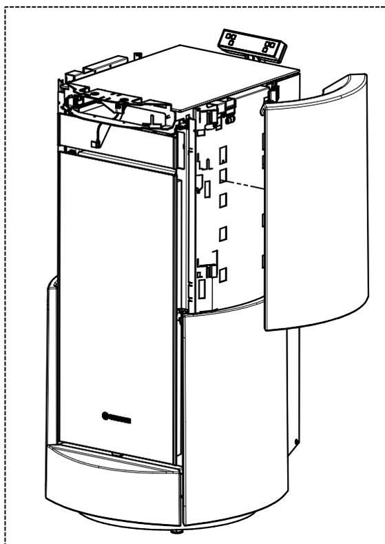
7 - Infilare il fianco inferiore (E) negli appositi dentini, come nei dettagli C e D. Deformare leggermente i dentini in modo da rendere solidale la maiolica al corpo. Eseguire la stessa procedura sul fianco opposto.
