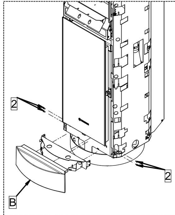
2 - Svitare le 4 viti (2) e rimuovere la staffa sorreggi maiolica. Infilare la maiolica inferiore (B) sulla staffa appena rimossa. Al termine fissare la staffa completa di maiolica con le 4 viti (2) appena rimosse.
