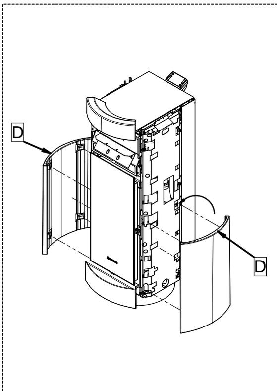
5 - Infilare il fianco inferiore (D) negli appositi dentini. Deformare leggermente i dentini in modo da rendere solidale la maiolica al corpo. Eseguire la stessa procedura sul fianco opposto.
