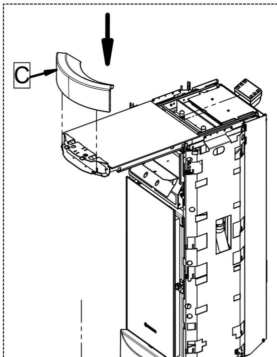
3 – Estrarre il vassoio ed infilare la maiolica superiore (C) negli appositi dentini. Deformare leggermente i dentini in modo da rendere solidale la maiolica al corpo.
