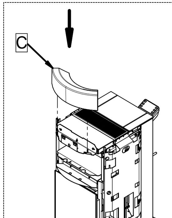
4 - Infilare la maiolica superiore (C) negli appositi dentini. Deformare leggermente i dentini in modo da rendere solidale la maiolica al corpo.
