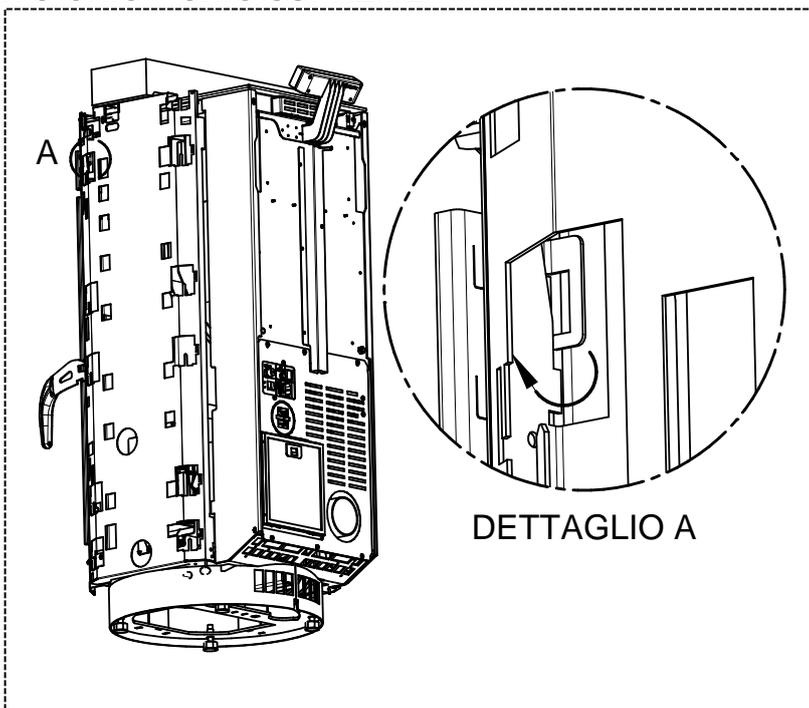
5 - Montare i quattro profili di compensazione, (I-L-M-N), incastrando i gancetti degli stessi, nelle apposite insenature presenti sul corpo dell'apparecchio. In qualche caso è necessario spezzare l'ultimo gancetto in basso del profilo superiore.
