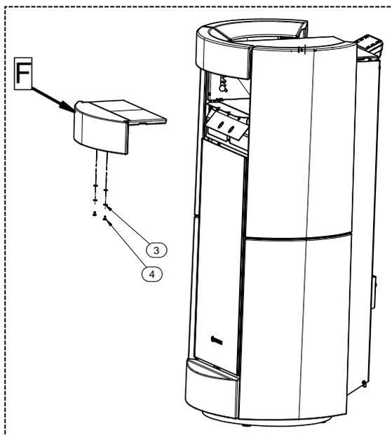
7 - Solo per i prodotti ad aria, infilare la maiolica centrale (F) come indicato in figura. Fissarla poi con le viti (4) e le rondelle (3).
