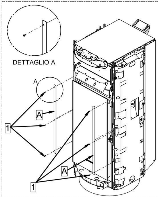
1 - Montare i due profili di compensazione (A) con le viti (1) ai fianchi dell'apparecchio, come indicato nella figura.
