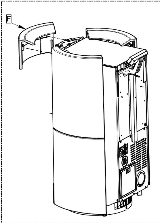
10 - Infilare la maiolica superiore (F) negli appositi dentini. Deformare leggermente i dentini in modo da rendere solidale la maiolica al corpo.
