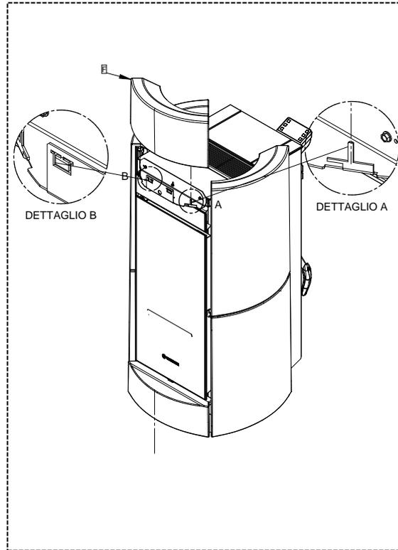
11 - Infilare la maiolica superiore (F) negli appositi dentini. Deformare leggermente i dentini in modo da rendere solidale la maiolica al corpo.
