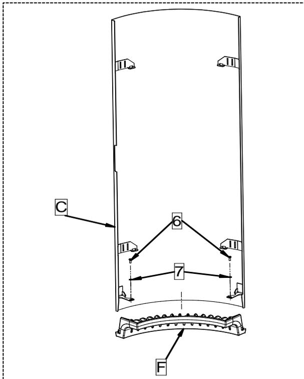
5 - Fixer l'élément supérieur latéral (F) au côté (C) à l'aide des vis (6) et des rondelles (7) toujours présentes dans le kit. Effectuer la même opération du côté opposé.
