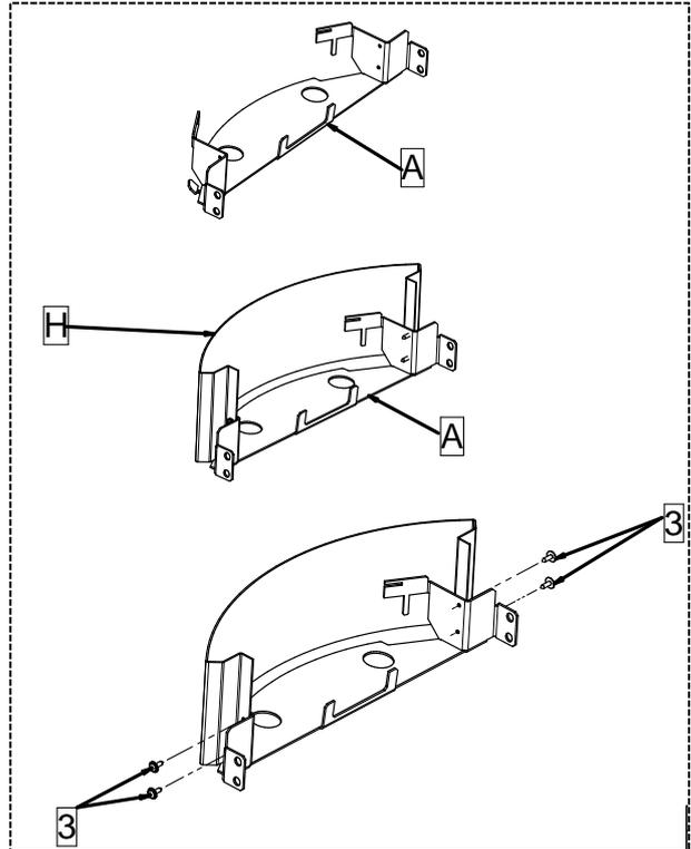
2 - Prendre le support inférieur (A) fourni avec le kit et fixer le profil calandré (H) à travers les 4 vis (3) incluses dans le kit.
