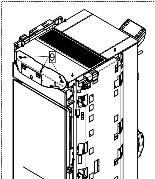
9 - Desserrer les 3 vis (9) situées sur la partie supérieure de l'appareil.
