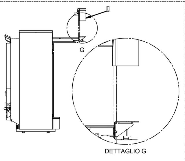
8 - Insérer l'élément supérieur central en fonte (L) dans la cavité créée et, si nécessaire, serrer les vis (8) préalablement desserrées.
