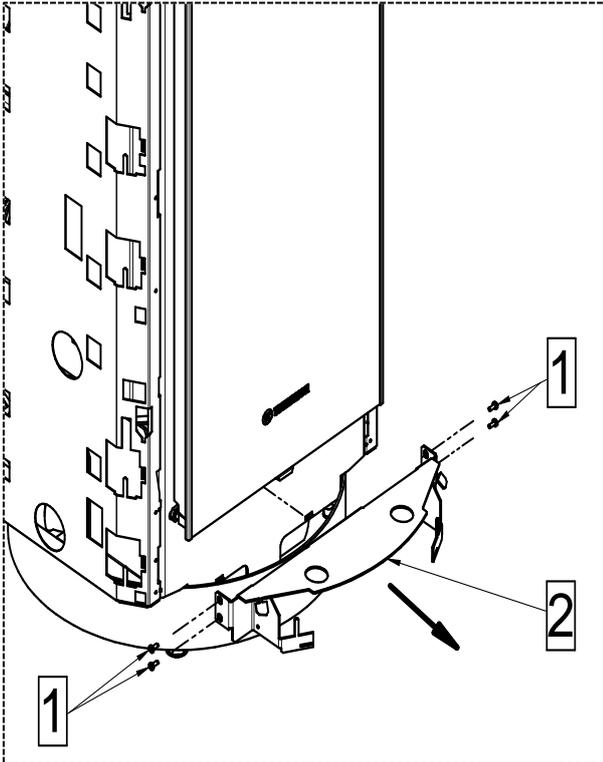
1 - Dévisser les 4 vis (1) et retirer le support inférieur (2) de l'appareil afin de l'éliminer.
