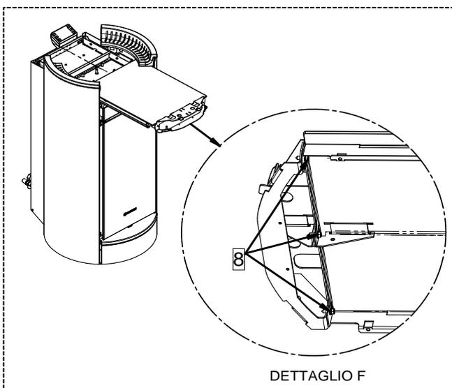
7 - Retirer le plateau de chargement des pellets et desserrer les 3 vis (8) ci-dessous comme détaillé.
