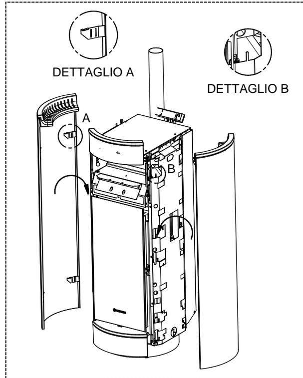
6 - Insérer le côté nouvellement créé dans les dents spéciales de l'appareil (voir détails). Effectuer la même opération du côté opposé.
