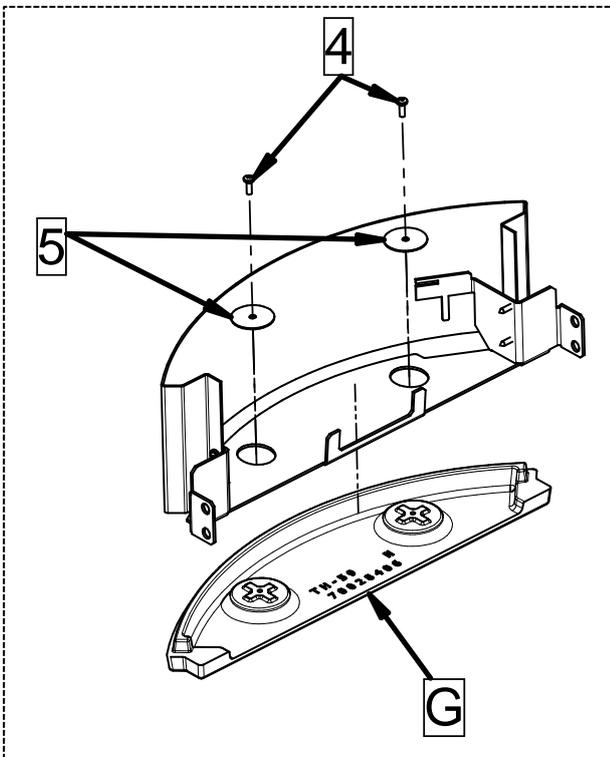
3 - Fixer l'élément inférieur en fonte (G) au support inférieur (A) qui vient d'être monté, à l'aide des 2 vis (4) et des 2 rondelles (5).
