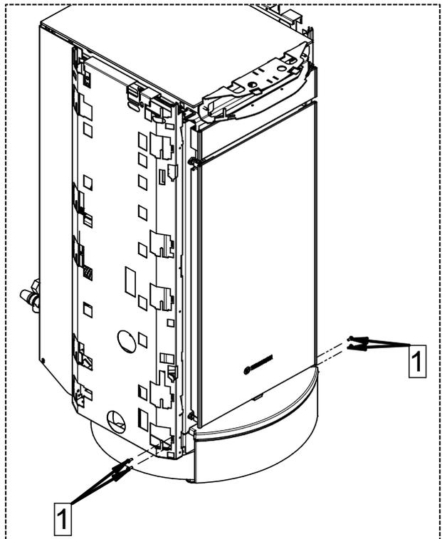
4 - Fixer l'ensemble nouvellement créée à l'appareil au moyen des vis (1) préalablement retirées.
