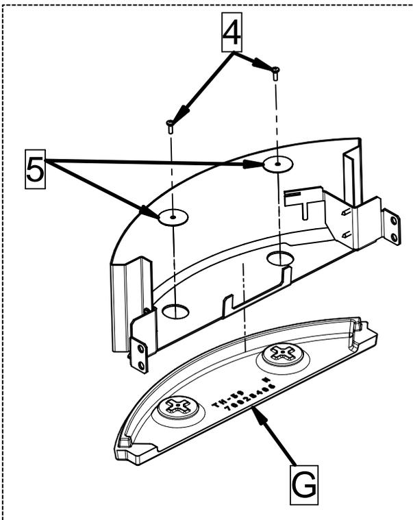
3 - Fixer l'élément inférieur en fonte (G) au support inférieur (A) qui vient d'être monté, à l'aide des 2 vis (4) et des 2 rondelles (5).
