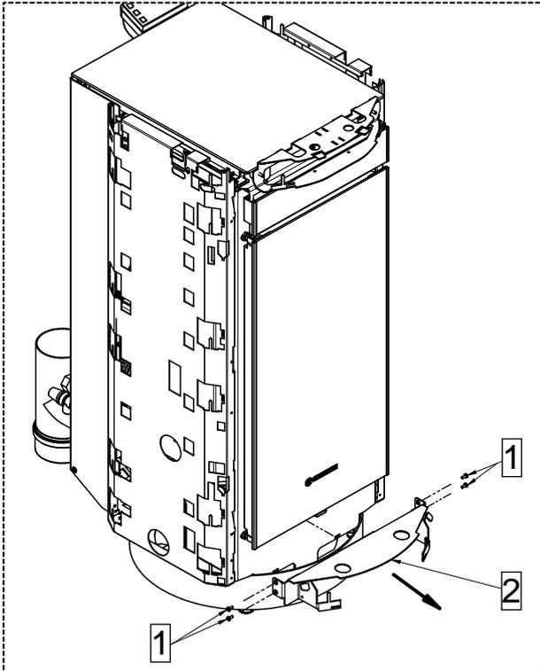
1 - Dévisser les 4 vis (1) et retirer le support inférieur (2) de l'appareil afin de l'éliminer.
