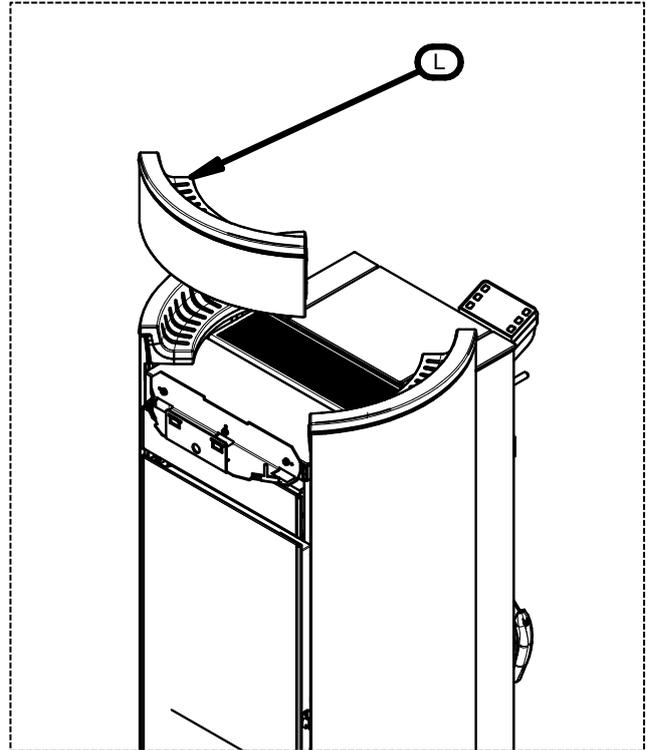
10 - Insérer l'élément supérieur central en fonte (L) dans la cavité créée.
