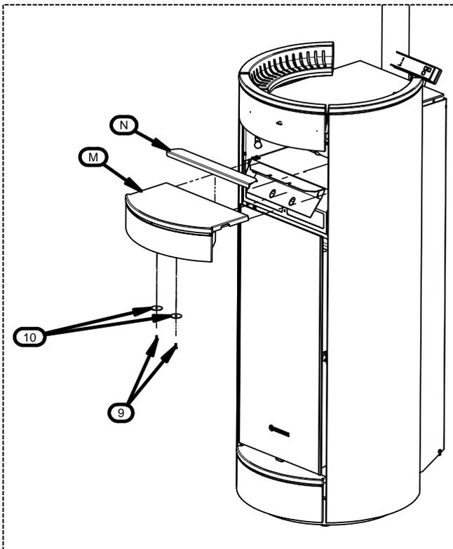
11 – Fixer la fonte pour four (M) avec les vis (9) et les rondelles (10) comme indiqué sur la figure. Uniquement pour le modèle PAIRPLUS 13, installer le profil esthétique (N).
