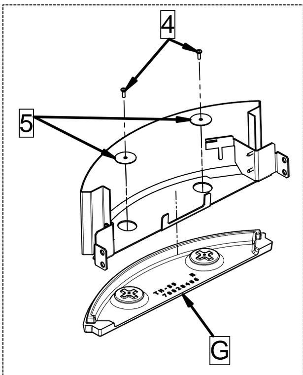
3 – Fissare la ghisa inferiore (G) alla staffa inferiore (A) appena assemblata, attraverso le 2 viti (4) e le 2 rondelle (5).
