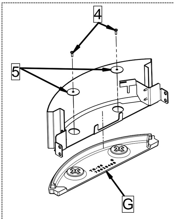
3 – Fissare la ghisa inferiore (G) alla staffa inferiore (A) appena assemblata, attraverso le 2 viti (4) e le 2 rondelle (5).
