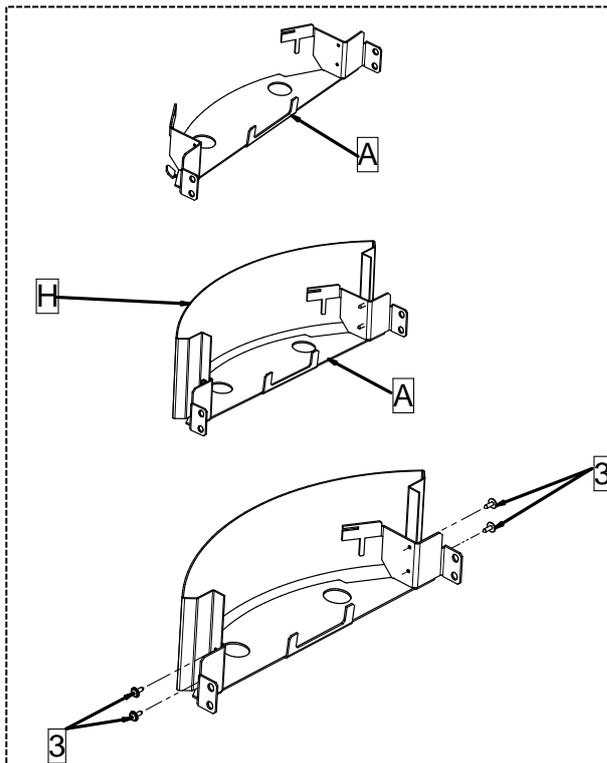
2 – Prendere la staffa inferiore (A) fornita con il kit e fissare il profilo calandrato (H) attraverso le 4 viti (3) presenti sempre nel kit.
