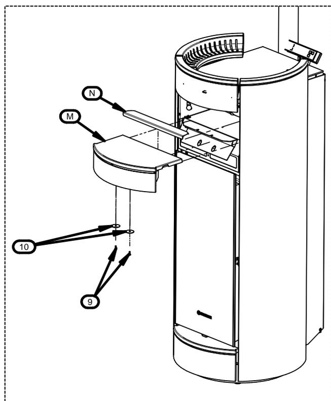
11 – Fissare la ghisa fornello (M) con le viti (9) e le rondelle (10) come indicato in figura. Installare solo nel modello PAIRPLUS 13 il profilo estetico (N).
