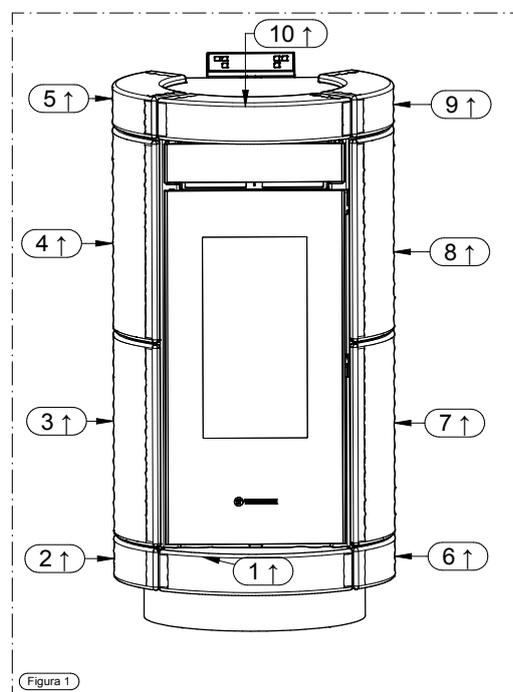
**ATTENZIONE, IMPORTANTE:** regolare con attenzione le ceramiche in particolare modo nella zona della maniglia verificando poi che durante l'apertura e la chiusura della porta la maniglia non tocchi la ceramica stessa.
